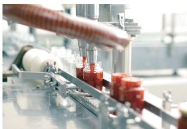
ジャムを瓶に自動充填するライン。気密性を保つための精密な制御が行われ、保存性と品質の両立を図っている
