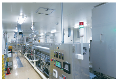
ジャム、ゼリーの殺菌ライン。充填・密封後の製品を連続的に加熱殺菌する設備で、微生物的リスクを確実に排除する
