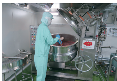
ジャムの煮込み作業。真空減圧釜を使用し、果実の風味を損なわないよう丁寧に炊き上げる
