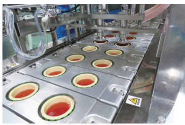
新宿高野を代表する「果実ピュアゼリー」(スイカ)の充填。容器の形状に合わせ、精密な自動充填が行われる
