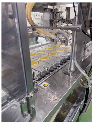
ゼリーの充填ライン。自動化されたラインで正確な量が容器に注がれる
