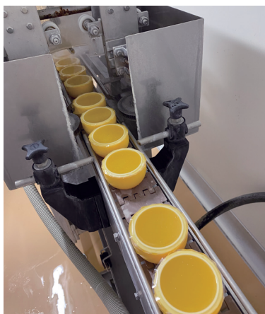
ゼリー殺菌前の洗浄ライン。充填・密封された容器の外側を洗浄し、フィルムの隙間に残ったゼリー液もきれいに落とし、容器のカビ汚れの発生を防止
