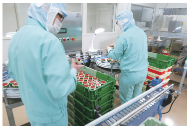
果実ピュアゼリーの最終検品。機械による検査に加え、最後は人の目と手で一つひとつの外観や密封状態を厳しく確認する
