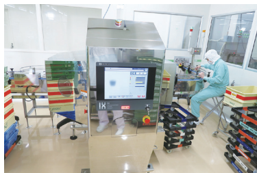
果実ピュアゼリーのX線検査。金属だけでなく、微細な異物の混入も見逃さないX線検査装置による高度な安全チェックが行われている
