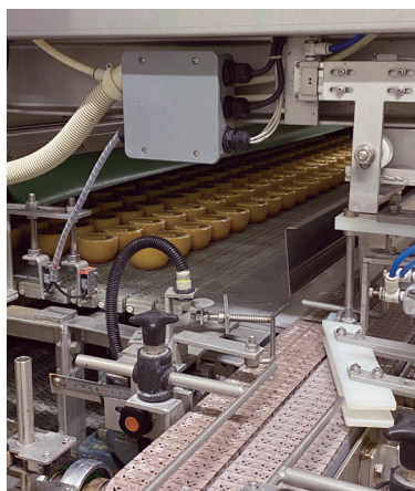
ゼリーの連続殺菌機入口。製品の安全性を担保する重要な熱殺菌工程で、コンベアにより連続的に殺菌槽へと送られる
