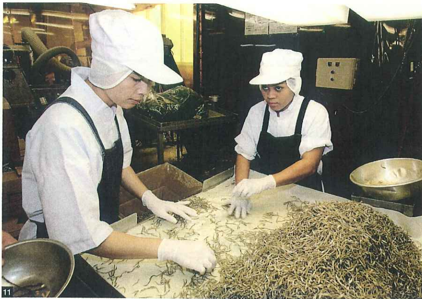
9・10・11 原料選別加工場は金属検出機も含めて、サイズ選別や比重、磁力、静電気などあらゆる方法を組み合わせて、異物選別を行っている。しかしこのライン上で除去可能な異物は7~8割程度まで。残り2~3割は人の目による目視選別になる。検査工程の作業環境として、照度基準を800ルクス以上で管理し、一定の明るさの下で選別を実施している
