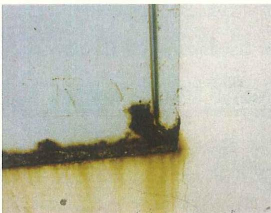
むき出しの製品ライン上機械でサビが発生している場合、それが落下し製品に混入することにより、金属探知機での不適合対象が増加する可能性が考えられる。
